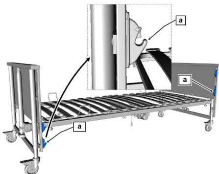
☞ Stecken Sie das eine Ende des Holms in die untere Aufnahmevorrichtung (kopfseitig).
