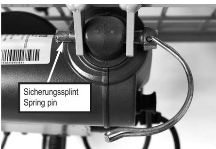
☞ Der zweite Anwender entfernt nun den Sicherungssplint. Schwenken Sie dafür den gebogenen Bügel weg und ziehen den Sicherungssplint mitsamt dem Bügel aus der Hubstange des Rückenlehnenmotors heraus.
