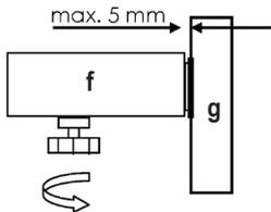
Zwischen dem Liegeflächenrahmen [f] und den Eckpfosten des Betthaupts [g] darf maximal 5 mm Abstand bestehen.
