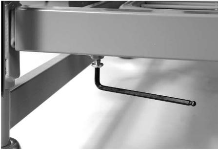
☞ Schrauben Sie die 4 Stück Inbusschrauben mit einem Inbusschlüssel gut fest.
