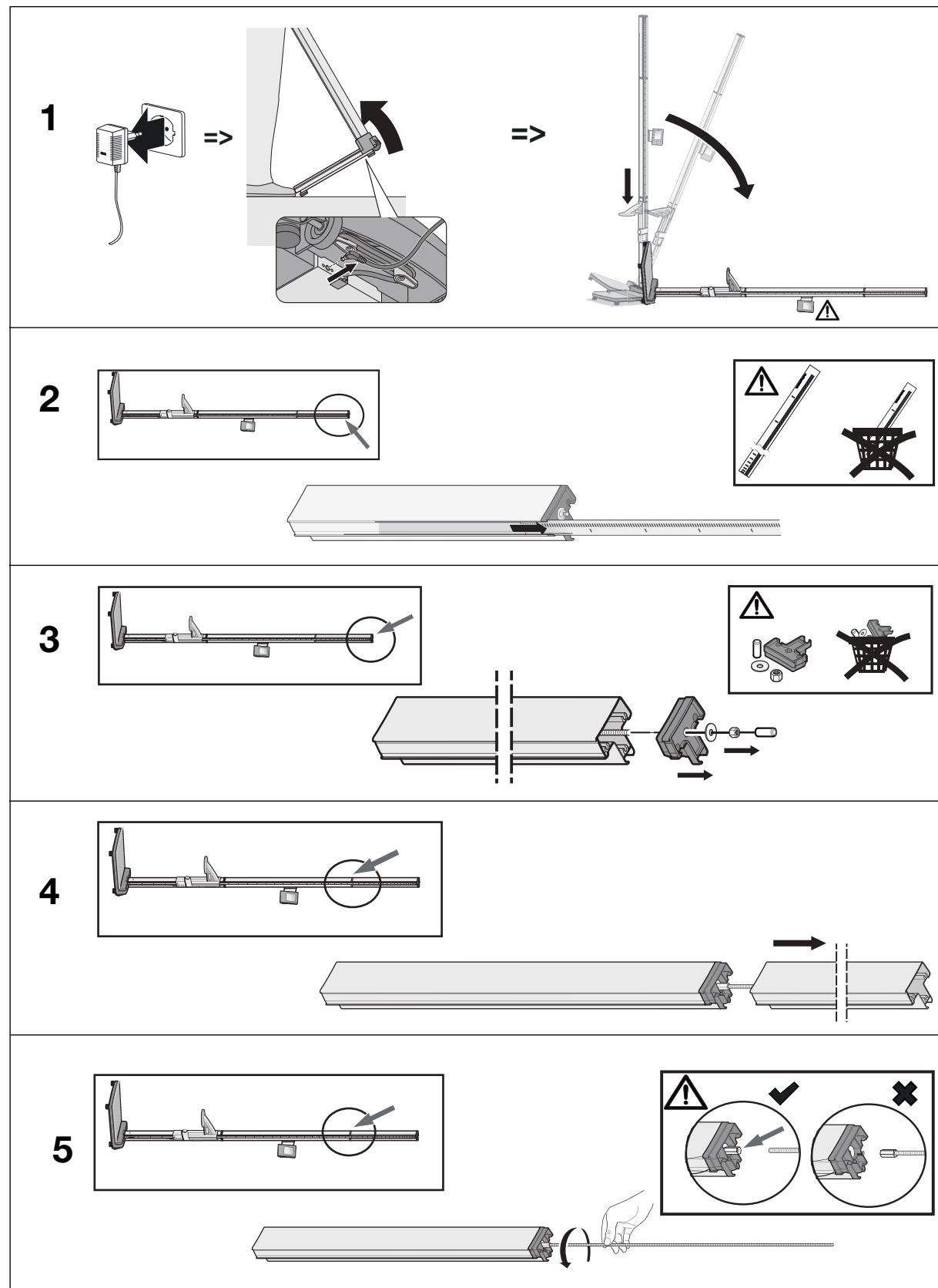
• Skala schneiden • Cut scale • Découper le ruban gradué • Recortar escala •
