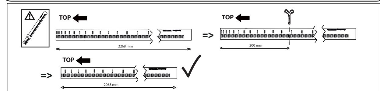
• Kurzes Säulenelement montieren • Install short column element • Monter l'élément court de la colonne • Montaje del elemento de columna corto •
